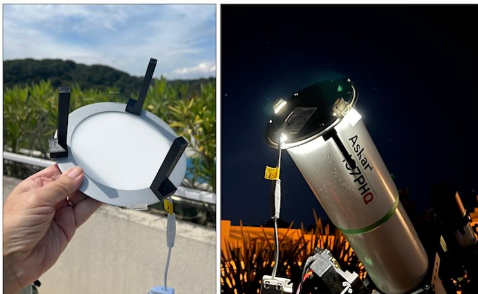
Attention, lors de l'acquisition du flat-field, à bien régler le temps de pose pour que l'intensité maximale dans l'image soit comprise entre 50 000 et 60 000 ADU. En revanche, évitez absolument de saturer le détecteur (au-dessus de 65 535 ADU). CCDCiel possède un petit outil qui vous informe si des parties de l'image sont saturées, en les coloriant :
