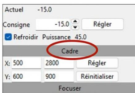
On notera au passage qu'il est possible de contrôler la température du capteur de la caméra « science » depuis l'interface principale, ce qui est fort pratique.
