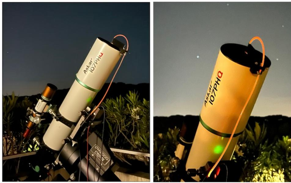
De cette manière, on imprime dans la même image électronique le spectre de l'étoile et celui de la lampe d'étalonnage en longueur d'onde. Cette technique, appelée « mode latéral », permet de corriger une grande partie des problèmes (notamment la perte de résolution spectrale) causés par les dérives mécaniques pouvant survenir lors de poses longues.
