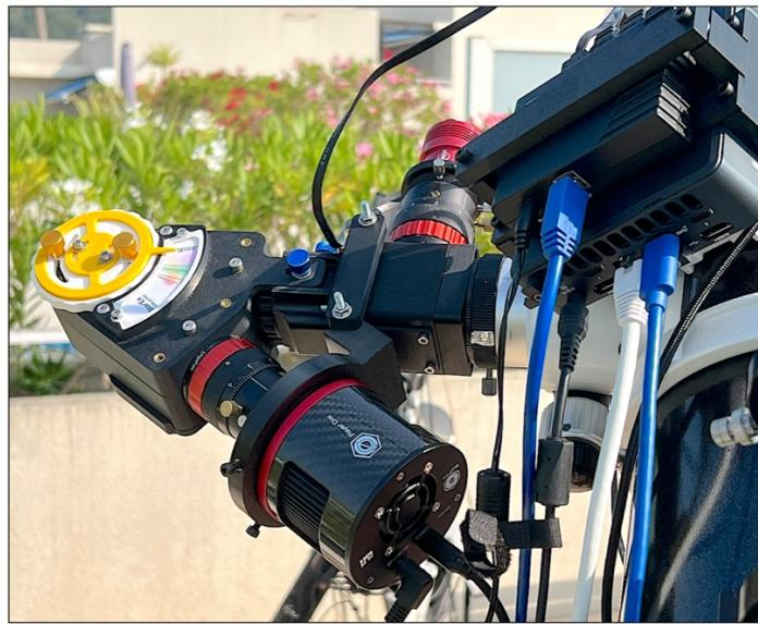
Une caractéristique essentielle que doit posséder le spectrographe est la capacité d'ajuster précisément le tirage optique de l'objectif in situ, sans aucun démontage. C'est par exemple le cas avec la version Azut3DPrint de Star'Ex, où une molette permet de faire cet ajustement en la tournant dans un sens ou dans l'autre :
