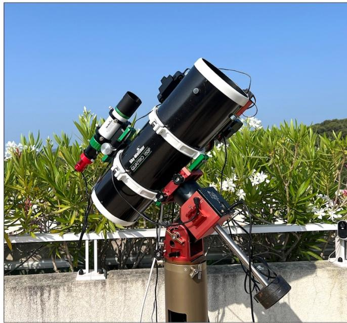
Le spectrographe est Star'Ex LR (by Azur3DPrint), monté directement au foyer Newton :
