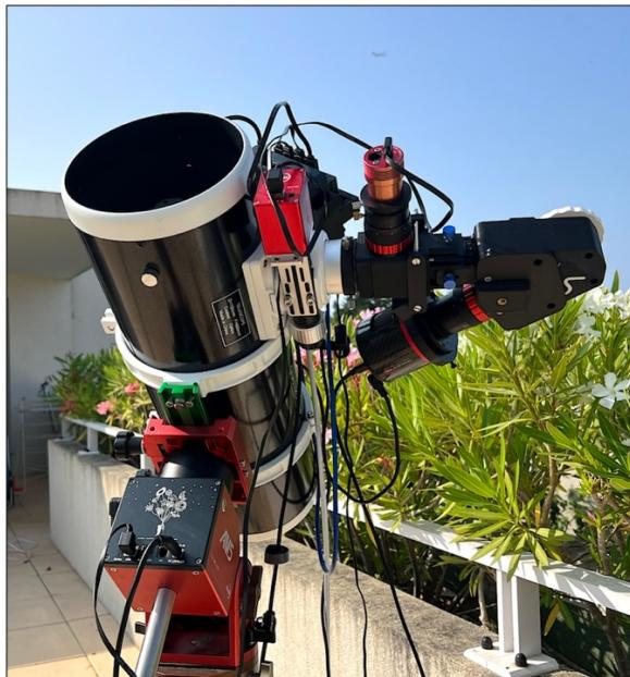
La caméra de science est un modèle Player One Uranus M Pro et la caméra de guidage est un modèle ZWO ASI290MM :
