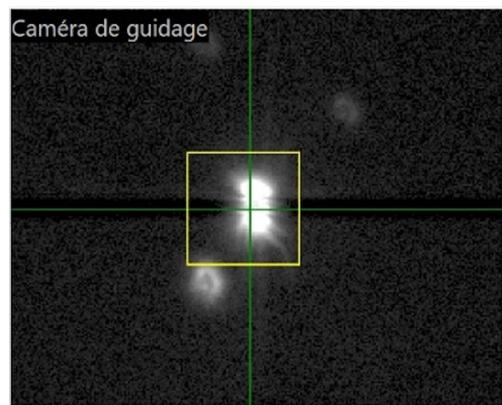
Ajuster la focalisation du télescope pour projeter une image bien nette des étoiles dans le plan de la fente d'entrée et obtenir des images fines des étoiles :
