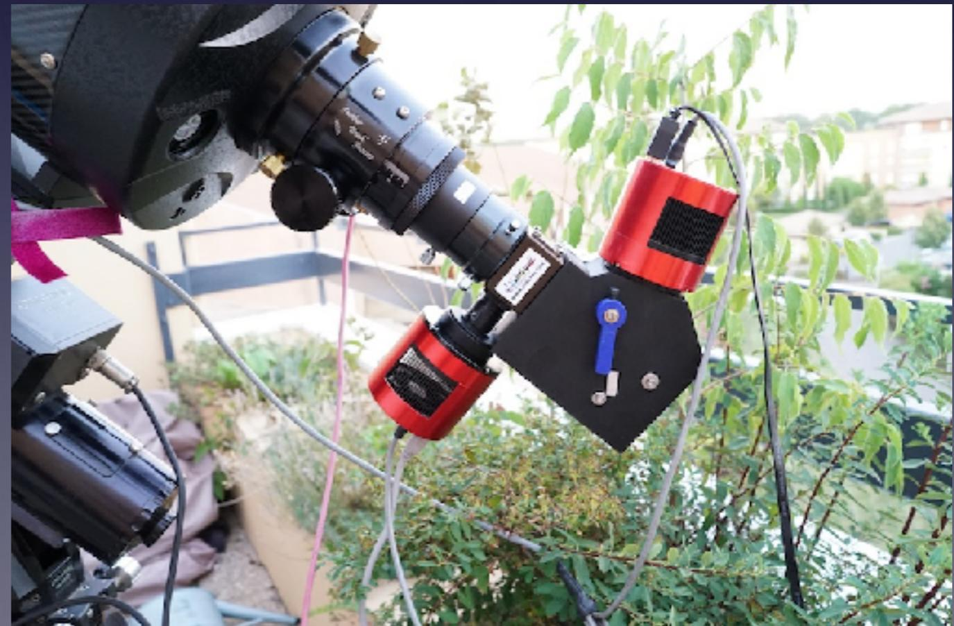
UVEX2 au foyer f/8 d'un télescope RC10 (GSO)
