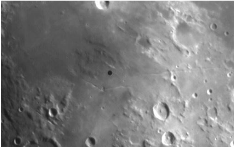
Bonnette : trou d'entrée du spectrographe de 50 microns
