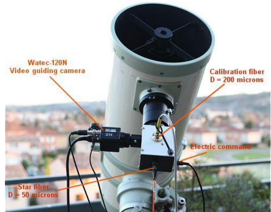
Fibre optique Très faible masse sur le télescope (et mise en route rapide)
