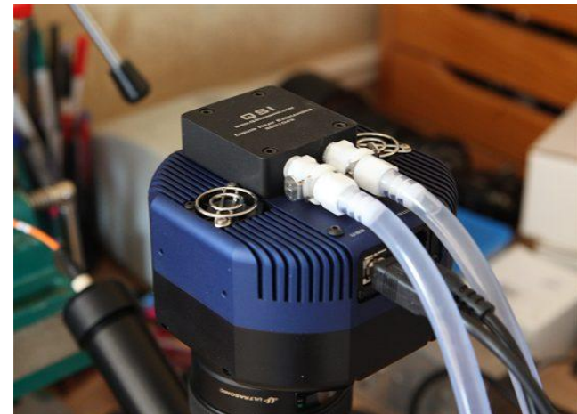
Refroidissement efficace (circuit d'eau sur caméra QSI)
