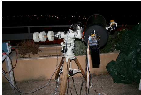
Fig. 1. Le spectrographe LHIRES3 au foyer F/10 d'un Celestron 11.
