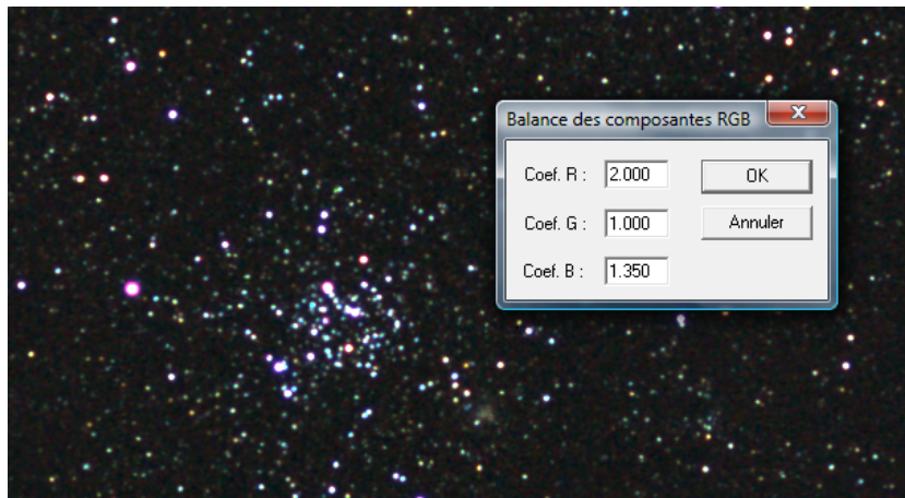
FIG. 13 – Une des images RAW d’origine seulement décodée. La couleur verte est typique d’un fichier RAW non traité. Elle traduit simplement le fait que le capteur utilisé est notoirement plus sensible dans le vert que dans le rouge ou le bleu. Noter aussi la présence d’un vignettage optique sensible dans la partie basse de l’image (c’est l’ombre du miroir reflex relevé des appareils photo au format APS-C qui obstrue notoirement le faisceau des optiques très ouvertes).
