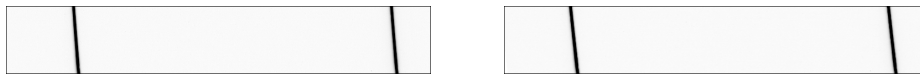
Fig. 8. A gauche, inclinaison des raies du neon au voisinage de H\alpha dans la première version. A droite, inclinaison des raies dans la seconde version.
