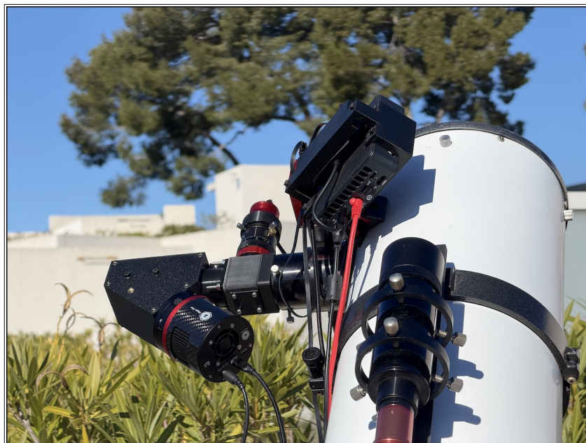
FIGURE 2 – Le spectrographe TinyStar'Ex au foyer d'un télescope Newton de 200 mm de diamètre.
