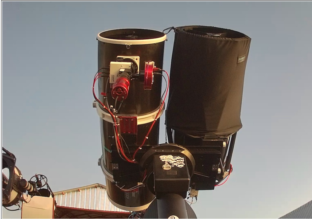
FIGURE 118 – L'équipement situé au Chili et opéré depuis la France par l'équipe 2SPOT. Le tube optique qui nous intéresse est celui situé à gauche : un télescope Newton 305 mm f/4 avec le spectrographe Alpy 600 au foyer.
