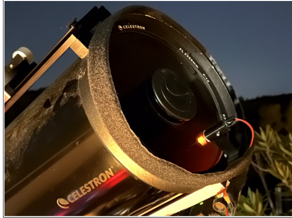
FIGURE 92 – Une autre approche consiste à placer directement la lampe d'étalonnage devant la pupille, sans passer par une fibre (le télescope est ici un Celestron C9.25).
