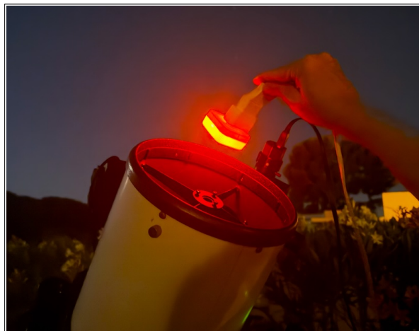
FIGURE 30 – Prise de vue du spectre de la lampe spectrale étalon (une veilleuse au néon).
