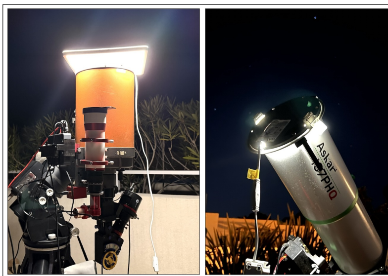
FIGURE 88 – Acquisition d'un flat-field à l'aide d'un panneau d'éclairage domestique à LED. Bien que le spectre des LED soit peu homogène sur l'ensemble du domaine visible, leur utilisation reste pertinente pour l'étalonnage de spectres haute résolution autour de H\alpha . L'image de droite montre le dispositif installé devant la lunette Askar 107PHQ ; à gauche, devant un vénérable Celestron 8 orange.
