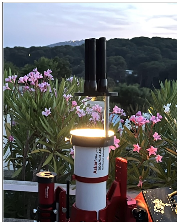
FIGURE 99 — Acquisition d'un flat-field à l'aide de lampes torches équipées d'ampoules à filament de tungstène (marque MagLite — attention à ne pas utiliser les modèles LED). Un diffuseur (feuille de papier calque) doit recouvrir l'entrée de la lunette. Rappelons que, dans le schéma de traitement présenté dans ce guide, l'obtention d'un tel flat-field (appelé en français « PLU », pour Plage de Lumière Uniforme) reste une option, et non une obligation. La fonction de ce flat-field est pour l'essentiel de gommer les différences de sensibilité pixel à pixel (PRNU = Pixel Response Non-Uniformity ), très discrètes avec les capteurs modernes.
