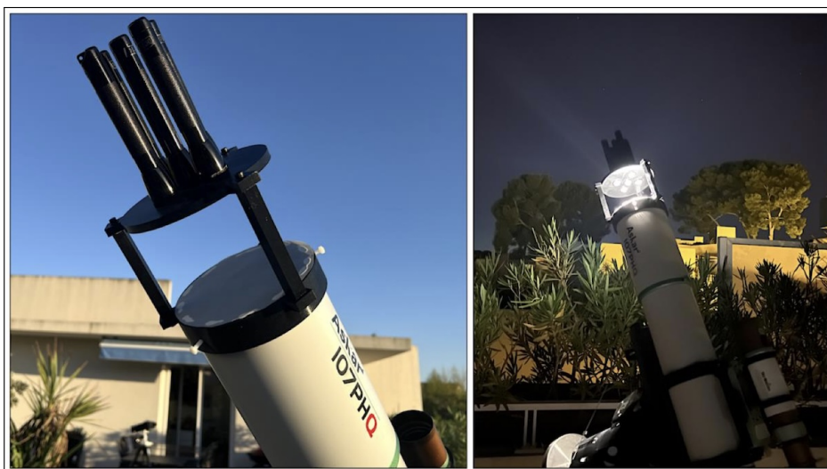
FIGURE 104 — Dispositif de prise de vue du flat-field en basse résolution, à partir de lampes à filament incandescent produisant un spectre de type « corps noir ».
