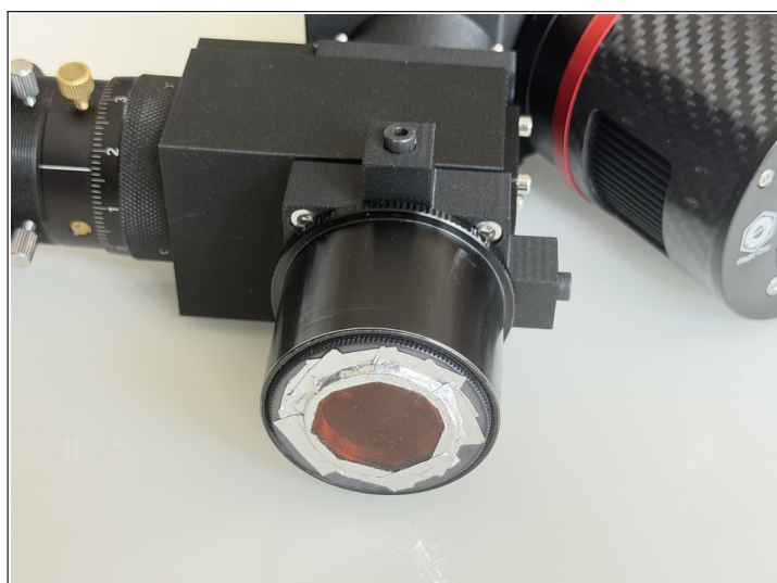
FIGURE 136 – Mise en place improvisée d'un filtre d'ordre à l'avant d'un spectrographe TSE en vue de prendre des images spectrales dans l'infrarouge.
