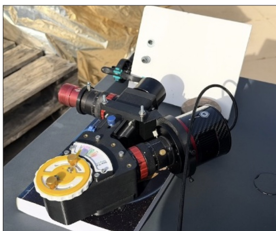
FIGURE 83 – Mesure des paramètres d'étalonnage d'un spectrographe, ici un Star'Ex LR.
