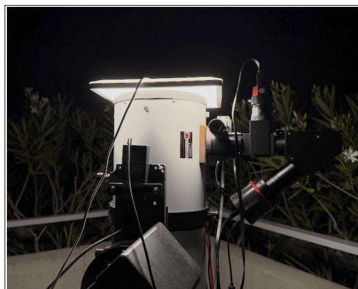
FIGURE 31 – Prise de vue du spectre de la lampe flat (un panneau LED).
