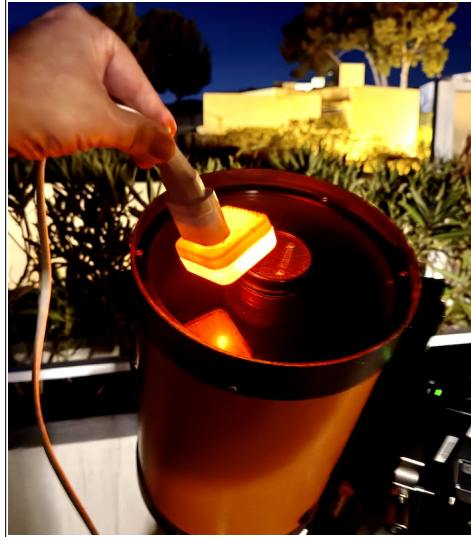
FIGURE 69 – Veilleuse au néon agitée devant l’ouverture du télescope afin d’obtenir un spectre de raies d’étalonnage en longueur d’onde dans une image spectrale distincte de celle que l’on cherche à étalonner (un spectre d’étoile, typiquement).
