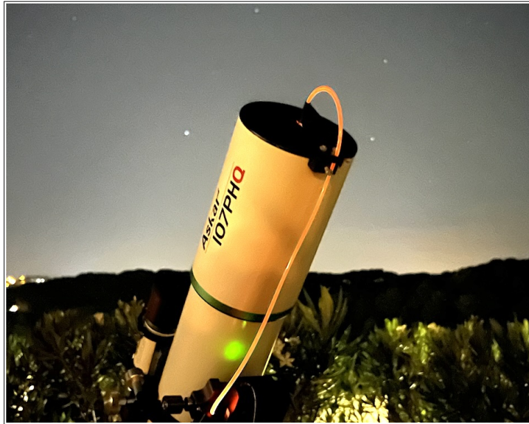
FIGURE 89 – Injection continue de la lumière d'une source d'étalonnage (ici une lampe néon) dans la pupille d'entrée de l'instrument en mode latéral . Une fibre optique plastique de 3 mm de diamètre est utilisée. Il est préférable d'éviter une source trop ponctuelle, afin de limiter les effets de speckle dans l'image des raies — d'où le diamètre relativement important de la fibre. L'obstruction induite reste négligeable et n'affecte pas significativement le rendement de l'instrument.
