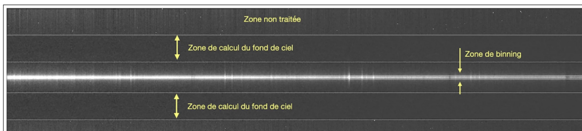
FIGURE 81 – Image du spectre de la comète C/2022 E3 (ZTF), prise le 31 janvier 2023 avec une lunette de 80 mm de diamètre et un Star'Ex LR équipé d'un réseau de 600 traits/mm. Nous ne souhaitons pas inclure, dans le calcul du fond de ciel, la lumière provenant de la coma de la comète (il faut donc éloigner les zones de calcul du fond hors de la zone d'influence de l'objet). Nous souhaitons également n'extraire que le spectre du noyau de cette comète (il faut donc choisir une zone de binning étroite). Cet exemple illustre la nécessité d'un ajustement manuel des paramètres du logiciel (paramètres bin_size et sky , voir le texte).
