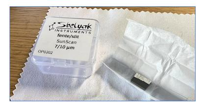
Un incident peut parfois nécessiter le nettoyage des deux faces de la lame de verre. Bien que les traitements appliqués sur celles-ci soient relativement résistants, il est important de rappeler qu'il s'agit de composants optiques, nécessitant des précautions particulières. Ne les frottez pas avec du papier ou un chiffon usagé, et évitez les produits de nettoyage standard, en particulier ceux destinés aux vitres domestiques.
