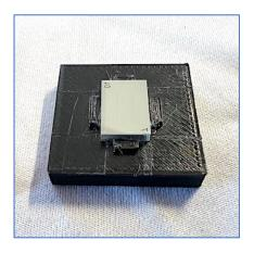
Il est important d'identifier la face de verre la plus concernée, à savoir celle recouverte de chrome. Pour rappel, dans le Sol'Ex, la face chromée de la fente (celle où la fente est photolithographiée, c'est-à-dire le plan exact de la fente) est orientée vers l'extérieur, de sorte que les inscriptions apparaissent à l'envers une fois installée.
