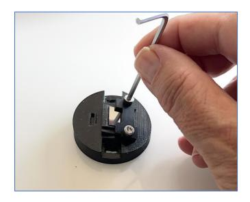
Ci-après, la fente GEN2 monté dans son support. Pour un usage avec Sol'Ex, il est recommandé de tourner la fente de telle manière que la face chromée soit vers l'extérieur (les écritures indiquant les largeurs de fente sont alors lues à l'envers) :
