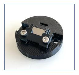
La fente Sol'Ex GEN2 installée dans l'instrument Sol'Ex :
