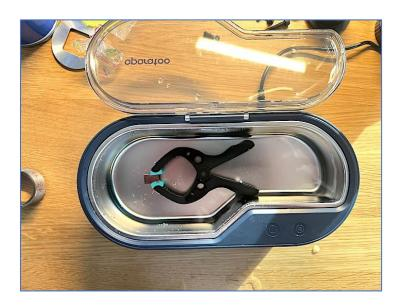
Maintenez la fente dans les mâchoires d'une petite pince de mécanicien avec embouts en plastique, la face chromée orientée vers le bas. Remplissez la cuve d'eau minérale. N'utilisez ni détergent ni savon, car cela risquerait de laisser des résidus au séchage ; utilisez uniquement de l'eau claire. Faites fonctionner la cuve pendant 4 à 5 minutes.
