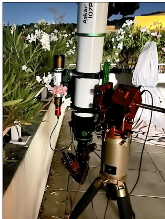
Figure 22. Lunette Askar 107PHQ sur laquelle est fixé Star'Ex, le tout sur une monture ZWO AM5.
