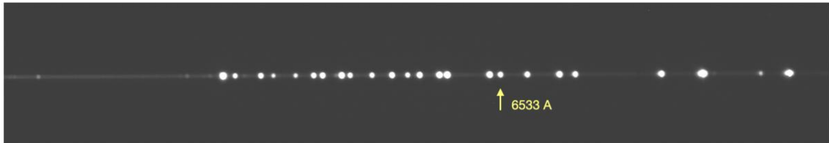
Figure 21. Après du spectre de la lampe néon pris au travers du trou de 25 microns une fois le réglage réalisé.
