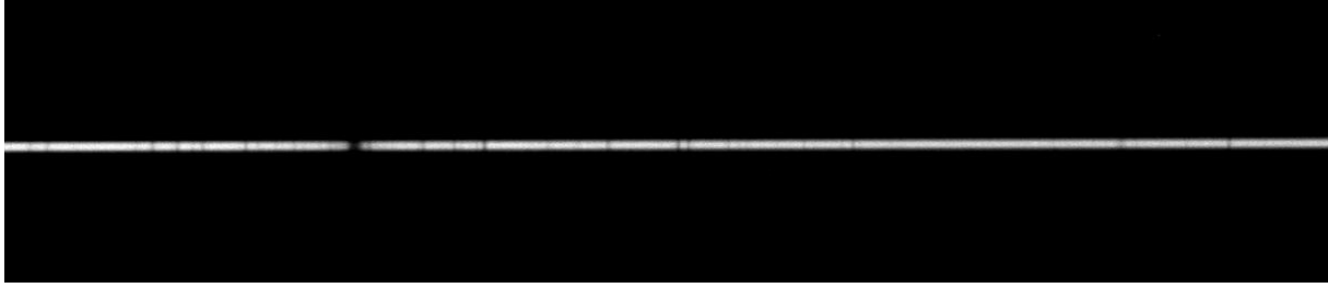
Figure 17. Spectre de la lumière du jour passant par le trou de 25 microns de diamètre. Cette trace du spectre anticipe celle que vous allez obtenir en observant des étoiles.
