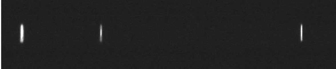
Figure 13. Par essais successifs, réduire la hauteur de la figure d'astigmatisme. Bien sûr, choisir le bon sens de déplacement du bloc pour améliorer l'image.
