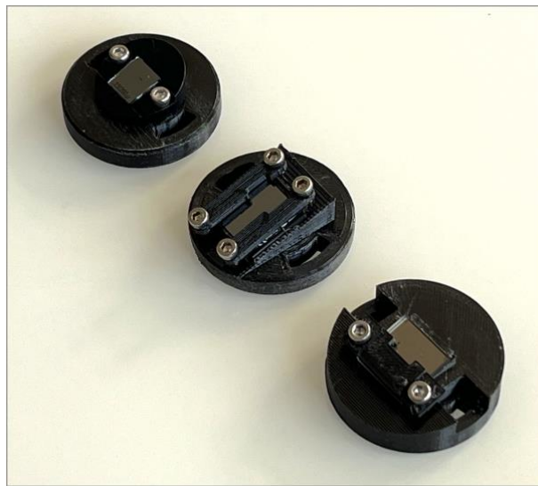
Figure 1. Un ensemble de fentes utilisables avec Star'Ex. A gauche, une fente initialement conçue pour le spectrographe Alpy600. Au centre, une disposition comportant 4 fentes de largeurs distinctes, au départ employée avec les spectrographes Lhires III et LISA de Shelyak. A droite, la nouvelle fente Sar'Ex GEN2 dans son support réalisé en impression 3D.
