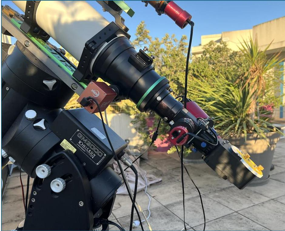
Le centre de la pupille d'entrée de la lunette est éclairé en continu par une fibre optique en plastique de 1 mm de diamètre, reliée à une lampe néon à l'autre extrémité. Nous travaillons donc en **mode latéral** : le spectre des raies de la lampe néon est enregistré simultanément avec celui de l'étoile. Nous nous concentrons sur une région du spectre couvrant la raie H-alpha ( $6563 \text{ \AA}$ ) et la raie rouge He I ( $6678 \text{ \AA}$ ).
