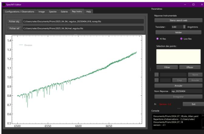
Pour construire la courbe de réponse il faut éliminer les raies telluriques et les variations liées au bruit. Deux modes sont disponibles : le mode « HiRes » recommandé pour des spectres en haute résolution ou le mode « LowRes » pour les spectres basse résolution. La différence est la méthode utilisée pour construire la réponse soit en ajustant une courbe sur des points, soit en filtrant le profil après avoir enlever les zones perturbées par des raies spectrales.
