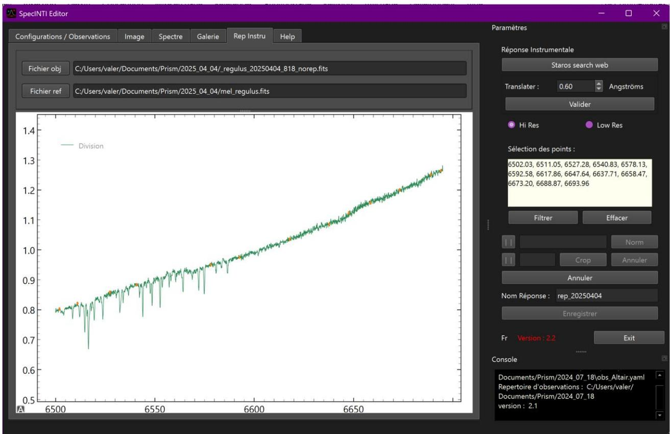
Avec la souris, placer des points sur la courbe de division en évitant les zones avec des raies spectrales. Une fois les points placés, cliquer sur le bouton « filtrer » pour afficher en orange la courbe de réponse instrumentale.
